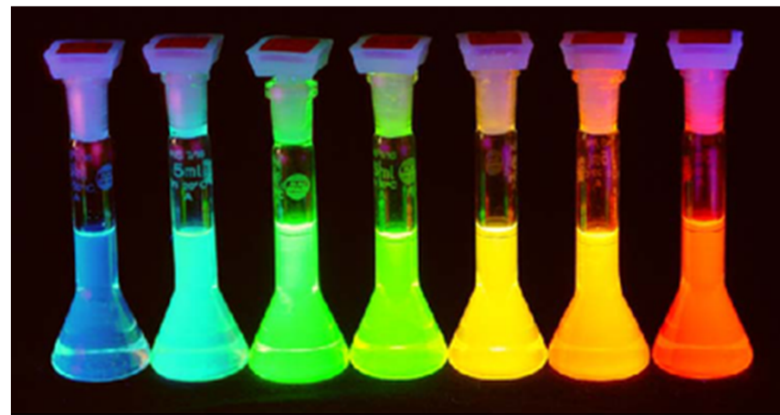
不同大小的 CdSe 量子點暴露在紫外光下會發出不同顏色的螢光（油溶性）
